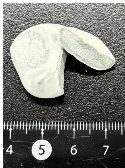
図 3.2 混合後 2 時間 30 分後のジオポリマーペースト
