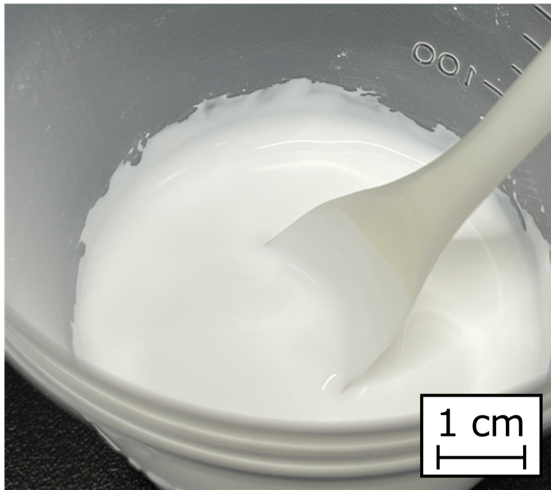
図 2.1: 脱イオン水溶媒のカルサイトペースト 10vol% の調製後の様子
