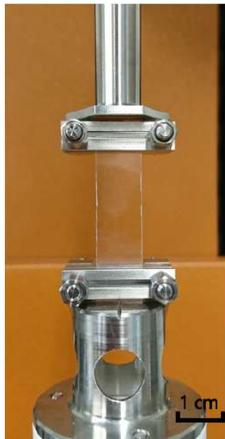
図 3.1 試料およびトーション治具 (上部のシャフトが回転することで試料にせん断を印加する)
