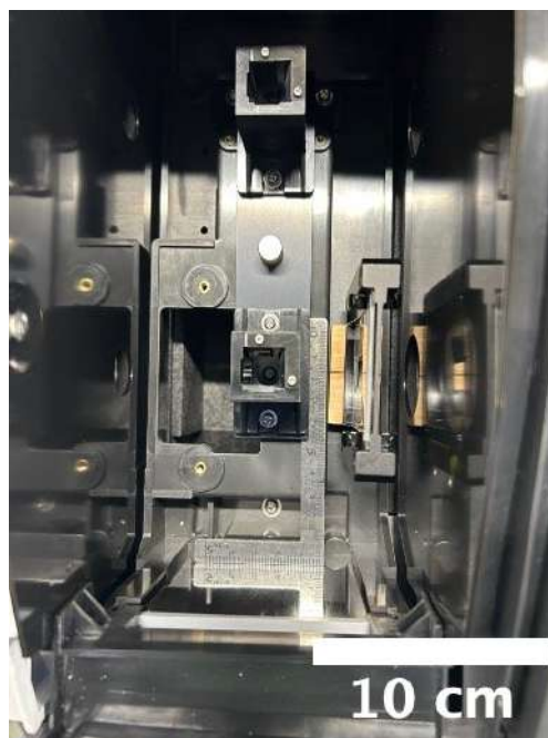
図 2.16: UV-Vis 試験片セット位置
