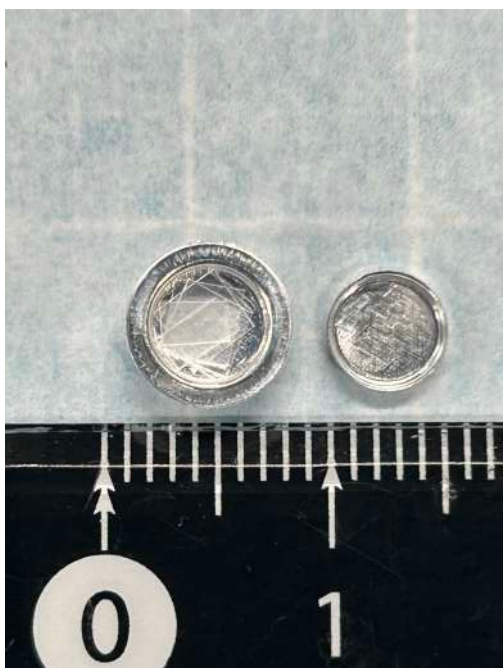
図 2.17: 左:pan に詰めた DSC 用試料片と 右:lid(中蓋)
