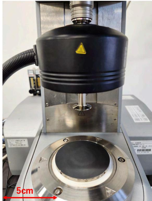
図 2.8 25 mm 径のコーンプレート治具と H-PTD200 を取り付けした MCR301
