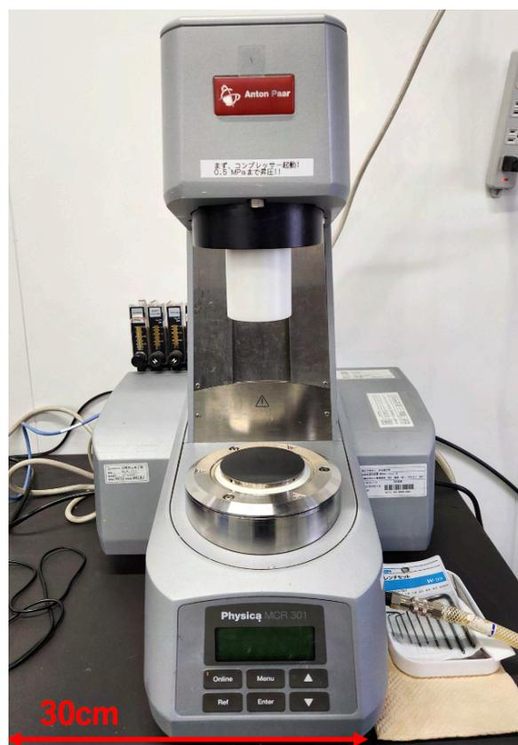
図 2.7 MCR301 レオメーターの外観
