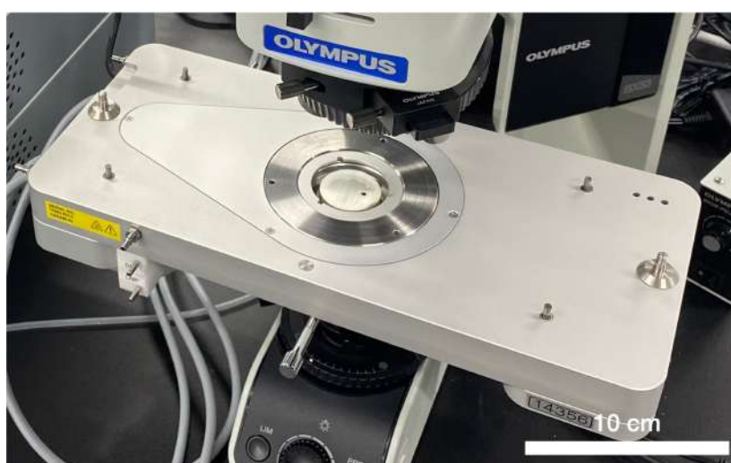
図 2.11 せん断ステージ内部の様子
