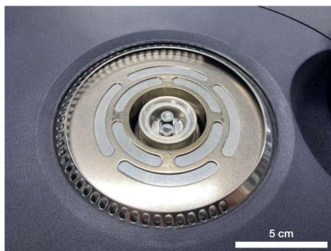
図 2.9 DSC25 炉内の様子
