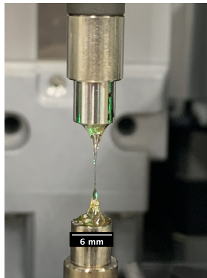
図 2.3 PS-P2VP の伸長粘度測定の様子
