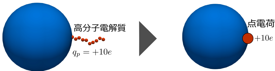
図 4.12 高分子電解質を同じ総電荷量を持つ点電荷に置き換えたモデル。点電荷は大きさを持たないとした。
