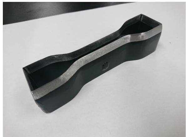
図 4.4 1 号試験片打ち抜き刃
