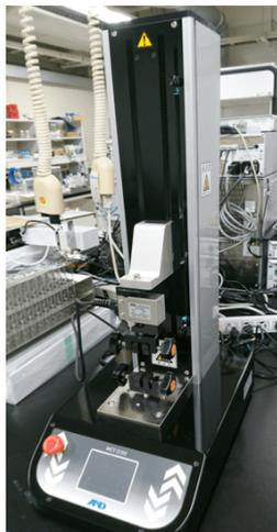
図 2.8 卓上型引張圧縮試験機 (フォーステスター)
